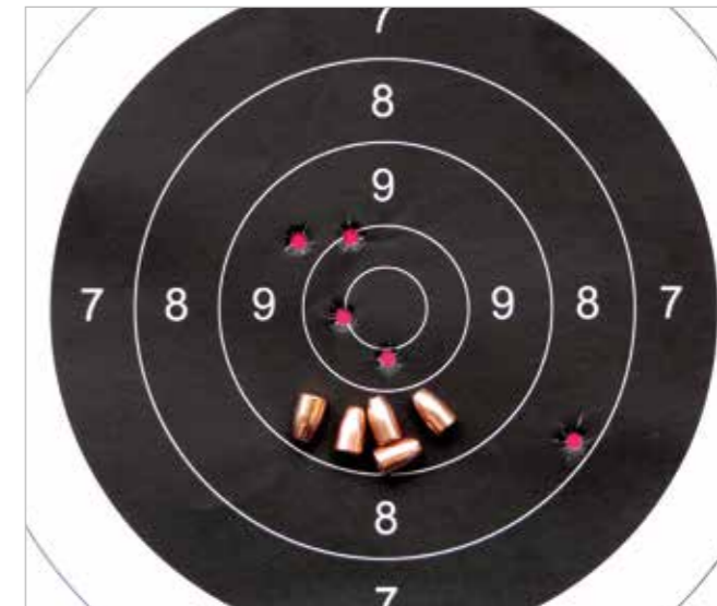
Un 47/50 a 25 metri in posizione regolamentare Uits con Beretta Px4 cal. 9x21 Imi, palla L.E. 125 Fprs, 4,3 grani di Vv N324, inneschi Magtech 1 1/2, Oal 28,60 mm. Il "8" a destra è stato dichiarato dal tiratore
