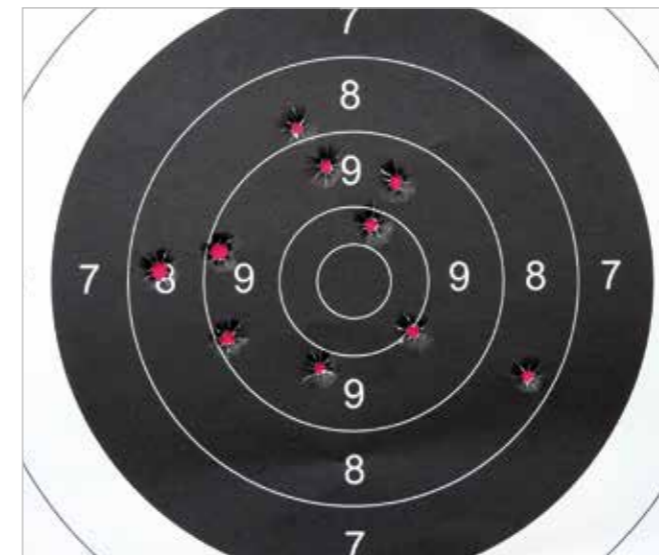
10 colpi a 25 metri nelle stesse condizioni della foto precedente ma con palla L.E. 115 Rn, 6,0 grani di Reload Swiss Rs20, inneschi Cci 550 Magnum, Oal 29,30 mm
