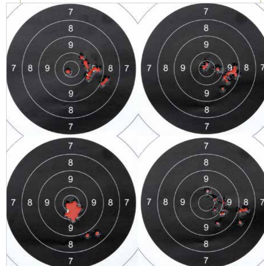
Rosate di 10 colpi a 25 metri in appoggio anteriore con palle L.E. e carabina Beretta Cx4 cal. 9x21 Imi dotata di "punto rosso" Burris. In alto, 115 grani Fprs e Rn; in basso, 125 grani Fprs e Rn. Per le valutazioni si veda il testo
